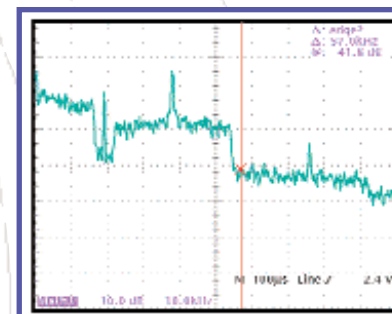
Spectre d'un écrêteur composite externe avec 2 dB d'écrêtage composite
